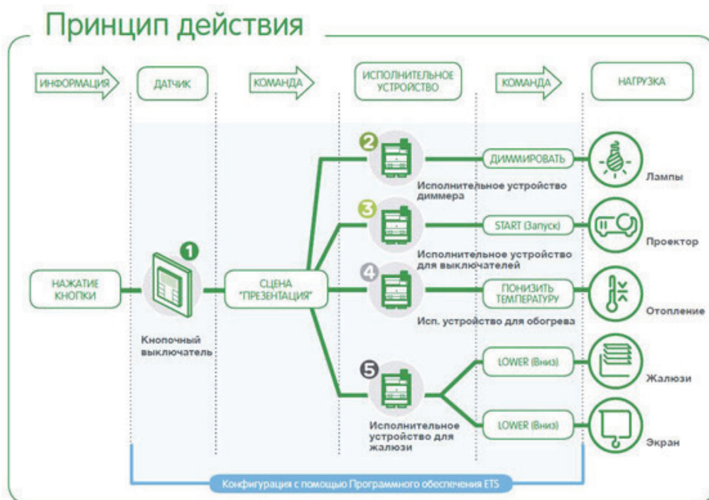
Рисунок 7.2. Принцип действия системы KNX
